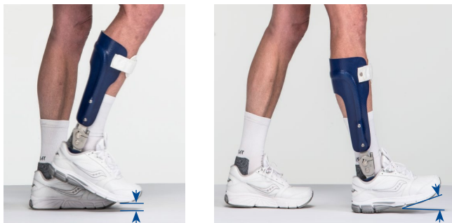
Abstand zwischen Zehen und Boden (links) und Winkel zwischen Fußsohle und Boden (rechts)
