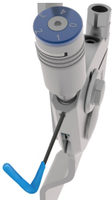
Abbildung 1 Lösen/arretieren Sie die PF-ROM-Einstellung mit dem 1,5 mm Innensechskantschlüssel, um den Gewindestift für die ROM-Arretierung zu lösen/anzuziehen.
