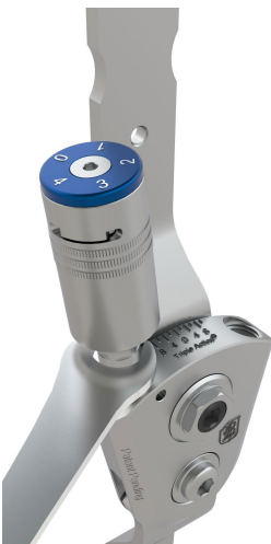
Abbildung 4. Stellen Sie die Druckfederverstärkung auf 15° ROM ein.
