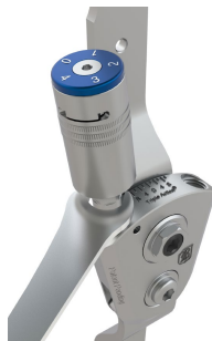
Abbildung 2 Stellen Sie die PF-ROM-Einstellung auf 0° ein, indem Sie die Druckfederverstärkung mit dem Einstellschlüssel eine ganze Umdrehung im Uhrzeigersinn drehen.
