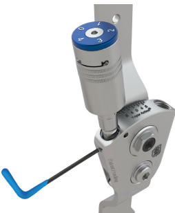
Abbildung 1 Lösen/arretieren Sie die PF-ROM-Einstellung mit dem 1,5 mm Innensechskantschlüssel, um den Gewindestift für die ROM-Arretierung zu lösen/anzuziehen.
