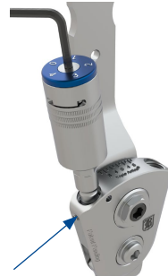
Abbildung 3 Lösen Sie die ROM-Skala-Schraube mit dem 2 mm Einstellschlüssel und stellen Sie die ROM-Stellung auf null, indem Sie die blaue ROM-Skala drehen. Der Gewindestift für die ROM-Arretierung dient als Referenz für diese Einstellung.
