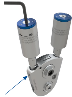
Abbildung 3. Lösen Sie die ROM-Skala-Schraube mit dem 2 mm Einstellschlüssel und stellen Sie die ROM-Stellung auf null, indem Sie die blaue ROM-Skala drehen. Der Gewindestift für die ROM-Arretierung dient als Referenz für diese Einstellung.
