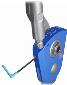
Fig. 1 Débloquer/bloquer l'ajustement d'amplitude à l'aide de la clé de 1,5 mm, et serrer/desserrer la vis de blocage de l'amplitude.
