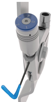
Figuur 1. Ontgrendel/vergrendel de PF ROM aanpassing met behulp van de 1,5mm zeshoeksleutel om de stelschroef voor de vergrendeling van de ROM los/vast te draaien.
