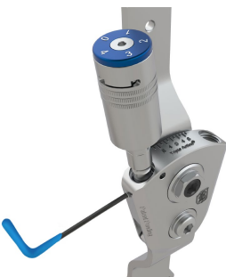
Fig. 1 Débloquer/bloquer l'ajustement d'amplitude de la flexion plantaire à l'aide de la clé de 1,5 mm, et serrer/desserrer la vis de blocage de l'amplitude.
