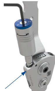
Fig. 3 Desserrer la vis du cadran d'amplitude à l'aide de la clé de réglage de 2 mm et positionner le réglage d'amplitude à 0° en tournant le cadran du réglage d'amplitude bleu. La vis de blocage de l'amplitude sert de référence pour ce réglage.
