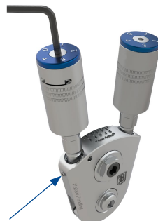
Fig. 3 Desserrer la vis du cadran d'amplitude à l'aide de la clé de réglage de 2 mm et positionner le réglage d'amplitude à 0° en tournant le cadran du réglage d'amplitude bleu. La vis de blocage de l'amplitude sert de référence pour ce réglage.
