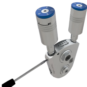
Fig. 1 Débloquer/bloquer l'ajustement d'amplitude de la flexion plantaire à l'aide de la clé de 1,5 mm, et serrer/desserrer la vis de blocage de l'amplitude.
