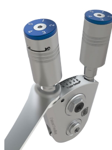
Fig. 2 Régler l'amplitude à 0° en tournant la tige de réglage au maximum dans le sens des aiguilles d'une montre à l'aide de la clé de réglage.
